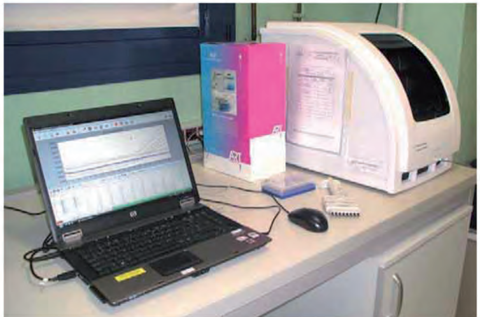
Figura 2 - Termociclature e PC con software integrato.
